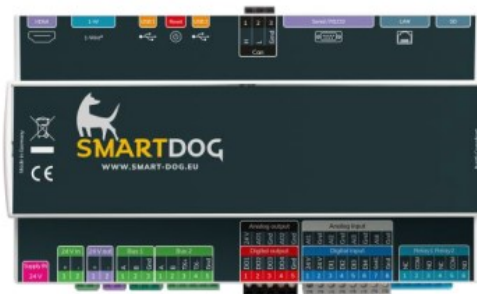
Abbildung 2-1 – Außenansicht der EZA-Regler SmartDog®1000 TS/PN/DR
